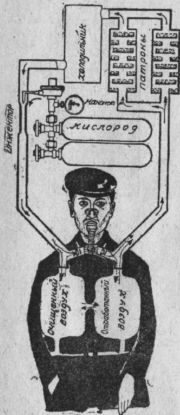
Рис. 6. Схема действия мундштучного респиратора Дрегера 1904—1909 гг.
