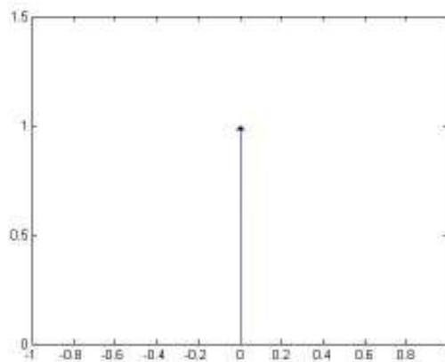
A priori conocemos que la función delta  $\delta(t)$  es el elemento neutro en la convolución. Por ende, debemos obtener la misma señal como salida. Al realizar los cálculos tenemos:
