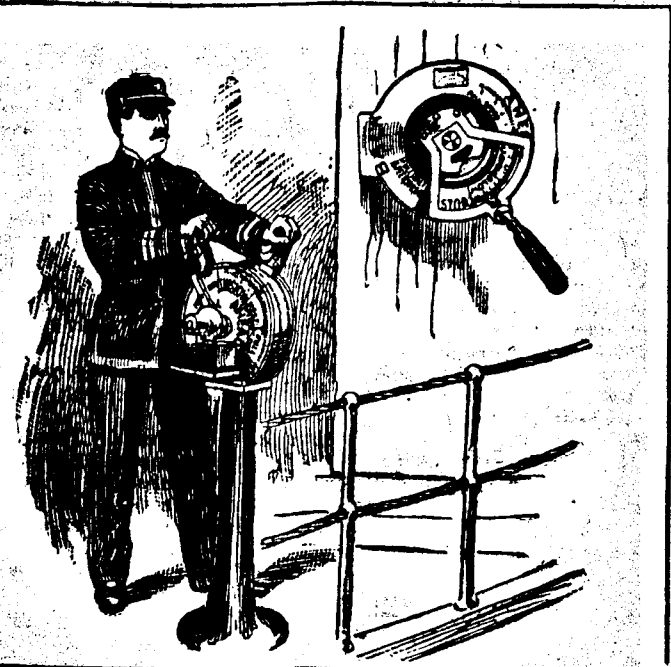
L'INVENTION DU LIEUTENANT FISKE. Le lieutenant Fiske de la marine des Etats-Unis, vient d'inventer un appareil électrique au moyen duquel il peut faire manœuvrer aisément les plus grands navires de guerre.
