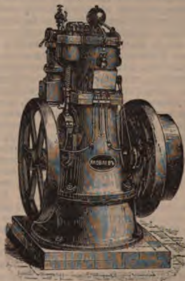
Рис. 7. Керосиновый двигатель Яковлева.
