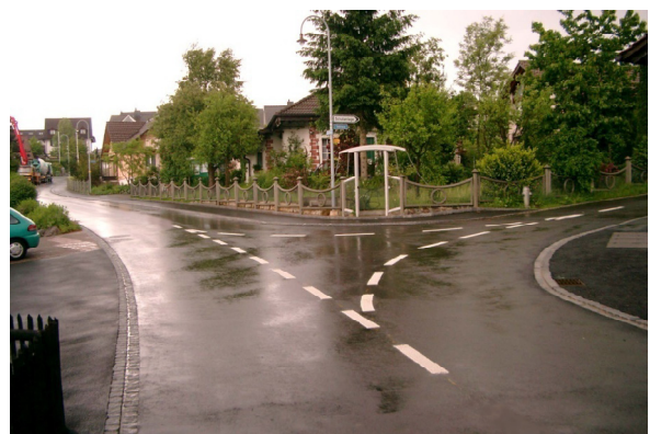
Abbildung 2 Verdeutlichung des Rechtsvortritts durch zusätzliche Markierung
