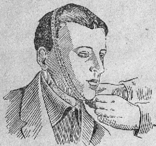
Рис. 8. Первое измерение головы при определении размера шлема противогаза
