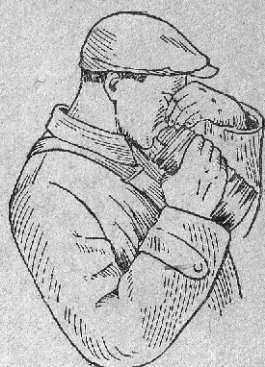
Рис. 18. Пользование противогазом при неисправности маски (шлема) или гофрированной трубки
