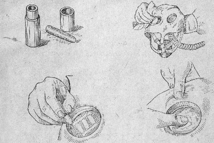
Рис. 15. Пользование «карандашом», предохраняющим очки от запотевания
