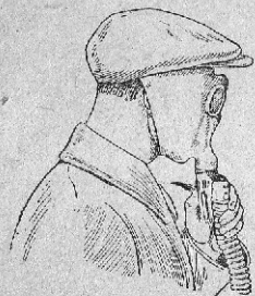
Рис. 19. Испорчен выдыхательный клапан у шлема (пропускает ОВ)—задержать дыхание, зажать большим пальцем левой руки выдыхательный клапан, сделать глубокий выдох и продолжать дышать (выдыхаемый воздух будет выходить из-под шлема около ушей)
