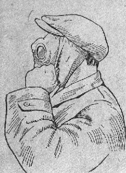
Рис. 16. Небольшой порыв шлема (маски) — зажать пальцами порванное место
