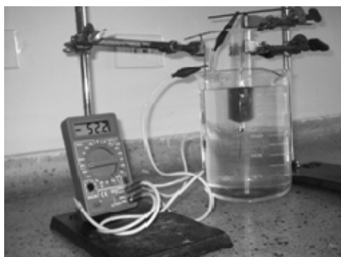
Fig. 1 Inclusión del Multímetro digital en el dispositivo original del OSCILADOR DE DENSIDAD.
