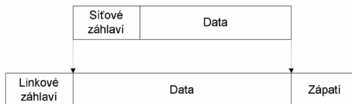
Obr. 1.6 Síťový paket a jeho vkládání (encapsulation) do linkového rámce
