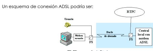
FS: Filtro separador (splitter) RTPC: Red Telefónica Pública Conmutada
