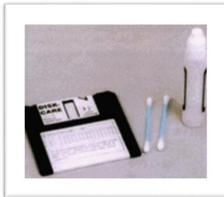
Para limpiar las cabezas con el disco especial, aplique en la ventana de éste tres o cuatro gotas del líquido que viene con el disco, o en su defecto, alcohol isopropílico. Insértelo en la unidad y haga girar el motor dando el comando DIR A: Repita el procedimiento dos o tres veces. Esto se debe hacer cuando se arme el equipo.
