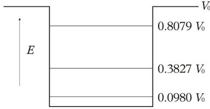
Figura 3: Diagrama de niveles de energía dentro del pozo cuadrado.
