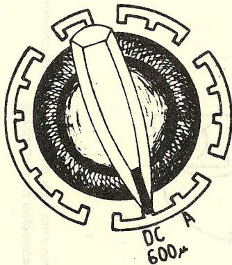
Fig. 168.— Ubicación de la llave selectora en el rango 2: 0 - 600 \mu A.
