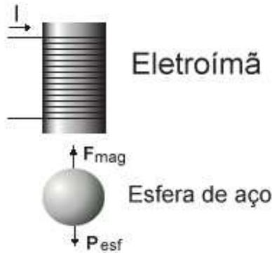
Fig.2 Sistema mecânico a ser controlado (eletroímã + esfera).
