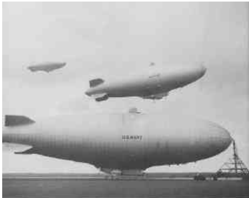
Abbildung 28: Am Mast ein ZPG-3W, darüber ein ZPG-2W
