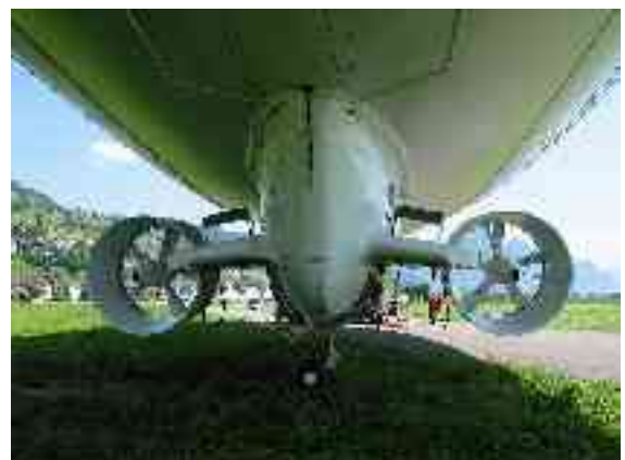
Abbildung 6: Über die Luftschutten hinter den Propellern werden die Ballonets aufgeblasen
