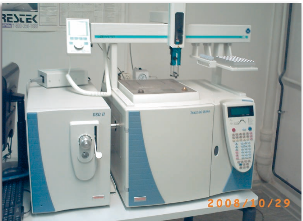
Bild 2: GC/MS-System DSQ II mit CTC PAL-Probengeber.
