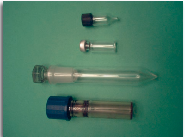
Bild 1: Verwendete Glasgefäße (von links nach rechts: Certanflasche, Spitzglas mit 14,5 Normschliff, Probenglas mit Aluminiumbördelkappe und Septum, Mikroflasche mit Schraubverschluss und Septum).
