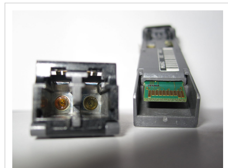
1000BASE-SX Transceiver SFP-Ausführung
