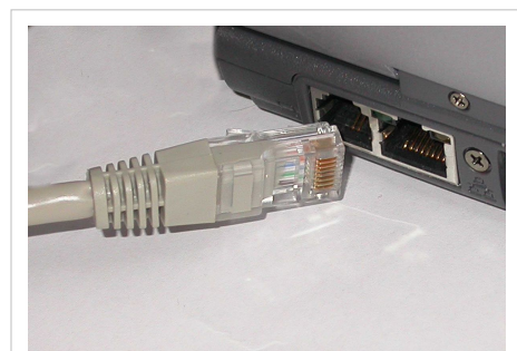
8P8C-Modularstecker und -buchse (Buchse ist rechts)
