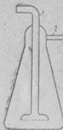
Рис. 13. «Гусек» для работы при испытании противогазов.
