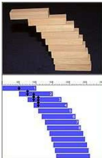
Aus der Divergenz der harmonischen Reihe folgt, dass man einen beliebig weiten Überhang mit gleichförmigen Bauklötzen bauen kann.
