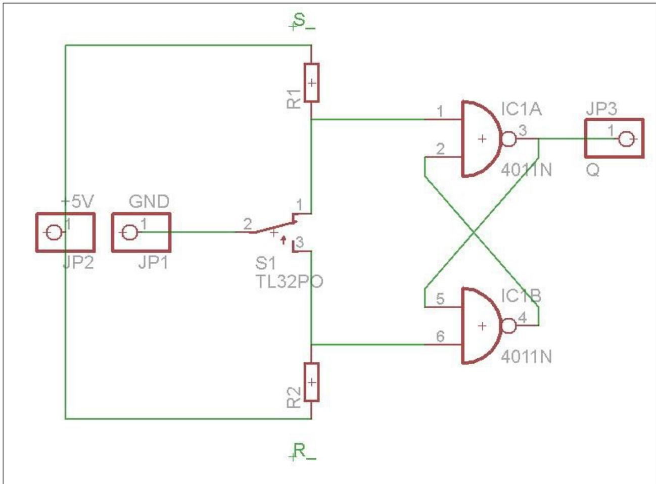
In dieser Schaltung wird das Setzen und Rücksetzen an einem NAND-Latch über mechanische Kontakte vorgenommen. Diese Schaltung wird als Entprellschaltung für Relais und Taster verwendet, da stets nur die erste Kontaktgabe wirksam ist.
